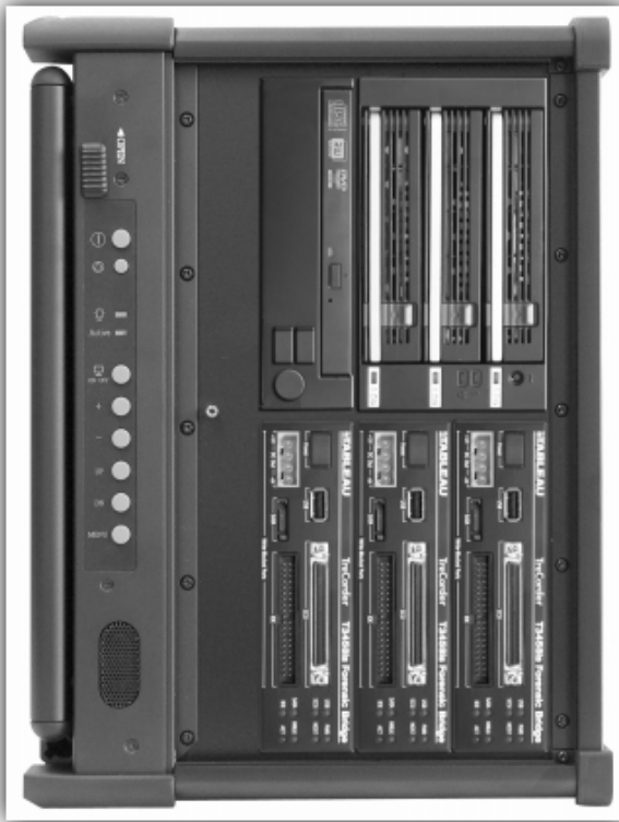
Bild 1.2: Der TreCorder kann drei Festplatten gleichzeitig über Schreibschutzmodule auf separate Platten sichern. Er ist auch in kleineren Ausführungen verfügbar
