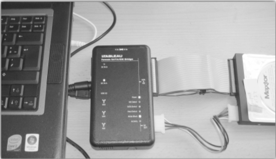
Bild 1.4: Eine Asservatplatte wird über ein externes Schreibschutzmodul an einen Laptop angeschlossen
