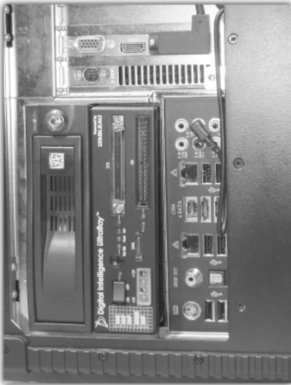
Bild 1.5: Internes Schreibschutzmodul, hier integriert in einen Forensik-Auswertecomputer
